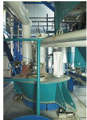
Figure 2: 位于混合机上部的配料系统
